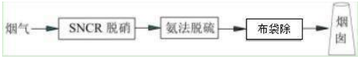
改造后3#生产线窑尾烟气排放路线图
