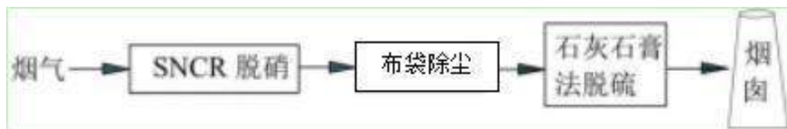
改造后2#生产线窑尾烟气排放路线图
